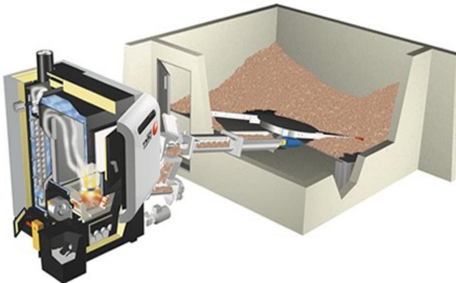
Ein Pelletskessel und -bunker im Aufriss. Hier lässt sich die Funktionsweise von Transport und Verbrennung der Pellets gut erkennen.
